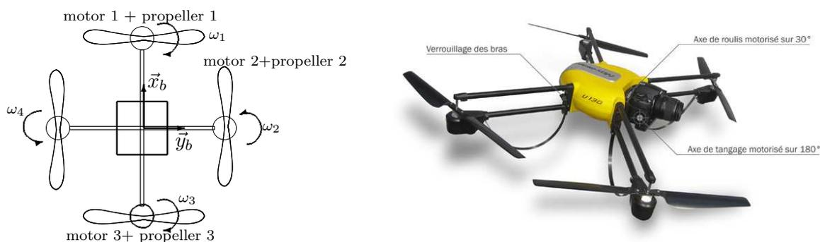
**Figure 9.1** – A gauche, vue schématique d'un quadrirotor. A droite, le U130 de Novadem
